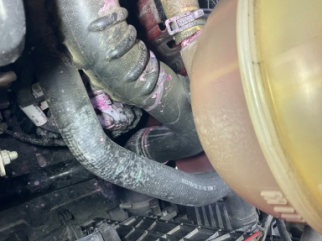
Motorsoğutması, Soğutma sıvısı > Sızdırıyor
