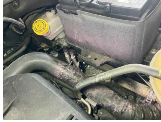
Motorsoğutması, Soğutma sıvısı > Sızdırıyor
