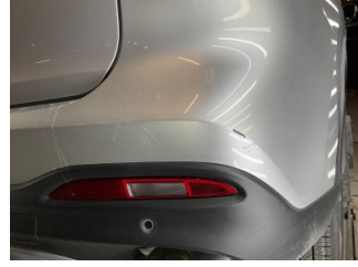
Tampon, arka, Arka tampon > Küçük Çizik
