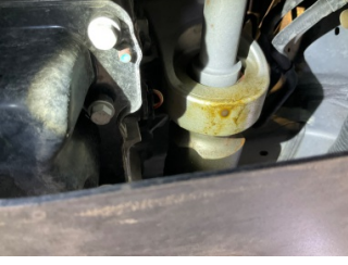
Ön aks, Aks mili, sağ > Yağ Kaçağı
