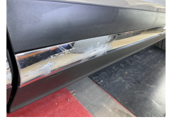
Kapı, sağ ön, Nikelaj, alt > Hasarlı
