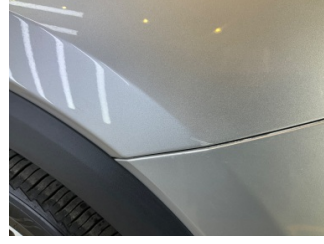
Çamurluk, sağ, Çamurluk, sağ > Küçük Çizik
