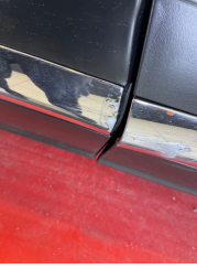
Kapı, sağ arka, Nikelaj, alt > Hasarlı
