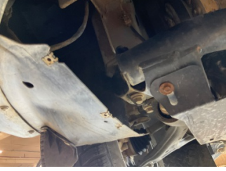
Tampon, ön, Tampon koruyucu orta > Hasarlı
