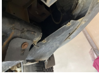
Tampon, ön, Tampon koruyucu orta > Hasarlı
