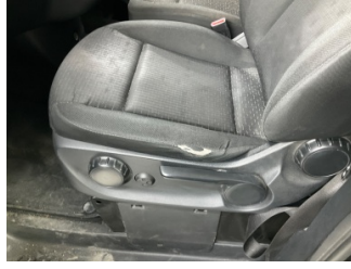
Koltuklar, ön, Koltuk ısıtması, sol ön > Dikişleri Açılmış
