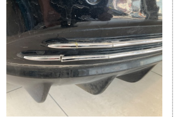
Tampon, arka, Spoiler > Kırılmış
