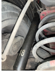
Arka aks, Amortisör, arka > Yağ Kaçağı
