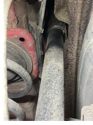
Arka aks, Amortisör, arka > Yağ Kaçağı
