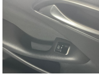
Kapı, sol arka, Cam/Ayna/Koltuk kumanda tuşları > Deforme Olmuş
