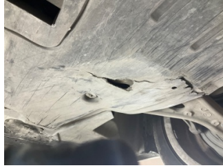
Motor, Alt muhafaza > Hasarlı
