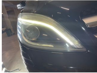
Farlar, Far camı, sağ > Deforme Olmuş
