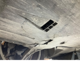
Motor, Alt muhafaza > Hasarlı
