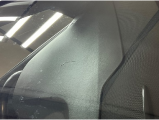
Camlar, Ön cam > Çatlak
