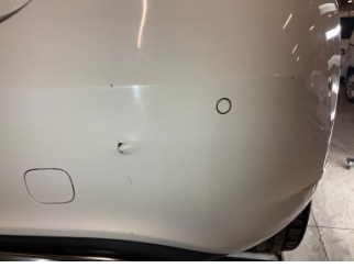
Tampon, arka, Arka tampon > Çatlak
