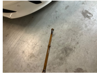
Motor, Yağ seviyesi > Eksik
