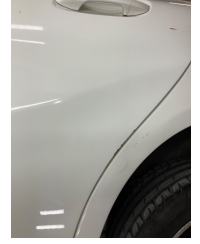
Kapı, sol arka, Kapı, sol arka > Boyası Atmış
