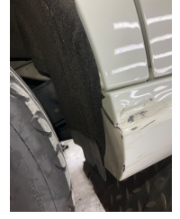
Marşbiyel, sağ, Marşbiyel plastiği, sağ > Hasarlı
