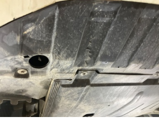
Tampon, ön, Tampon koruyucu orta > Kırılmış
