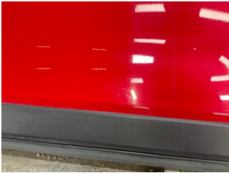
Kapı, sağ ön, Kapı, sağ ön > Taş İz
