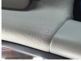
Döşemeler/Kapaklar, Tavan döşemesi > Yıpranmış
