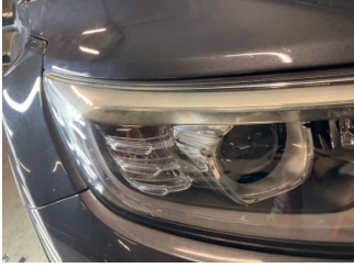
Farlar, Far camı, sağ > Deforme Olmuş
