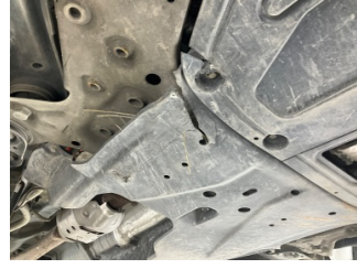
Motor, Alt muhafaza > Hasarlı
