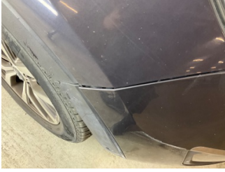
Tampon, ön, Ön tampon > Sabitlemesi Hatalı
