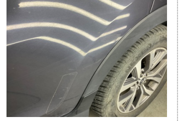
Kapı, sol arka, Kapı, sol arka > Çizik
