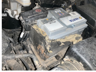
Elektrik donanımı/Pano, Akü > Yıpranmış
