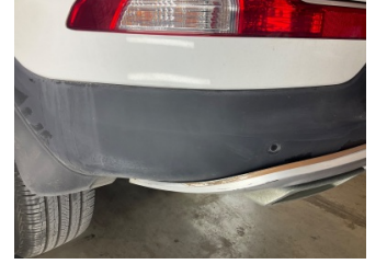
Tampon, arka, Arka tampon > Boyası Atmış
