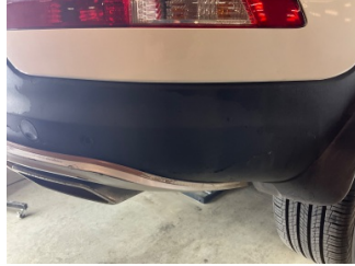
Tampon, arka, Arka tampon > Boyası Atmış
