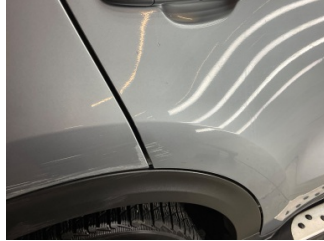
Kapı, sağ arka, Kapı, sağ arka > Çizik
