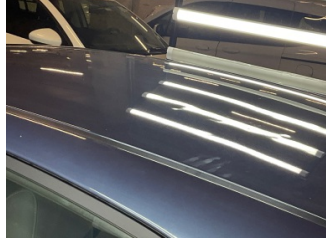
Tavan, Tavan > Dolu Hasarı
