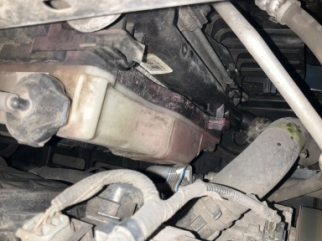
Motorsoğutması, Soğutma sıvısı > Sızdırıyor
