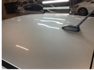
Tavan, Tavan > Dolu Hasarı
