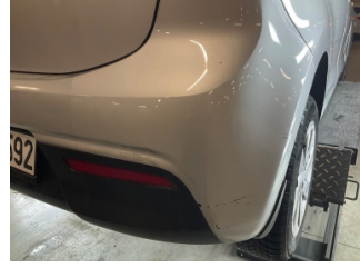
Tampon, arka, Arka tampon > Çatlak
