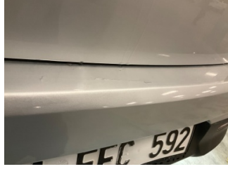
Tampon, arka, Arka tampon > Çatlak
