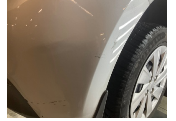
Tampon, arka, Arka tampon > Çatlak
