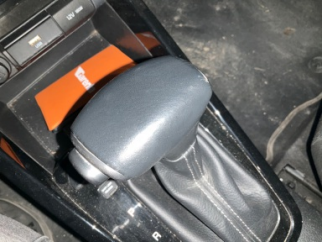
Şanzıman, Vites topuzu > Deforme Olmuş
