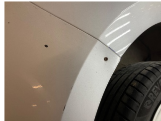
Tampon, arka, Arka tampon > Sabitlemesi Hatalı
