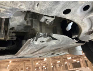
Motor, Alt muhafaza > Kırılmış
