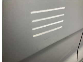
Kapı, sağ arka, Kapı, sağ arka > Çizik
