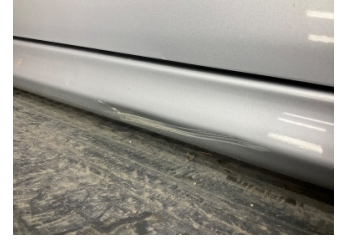
Marşbiyel, sağ, Marşbiyel, sağ > Hasarlı
