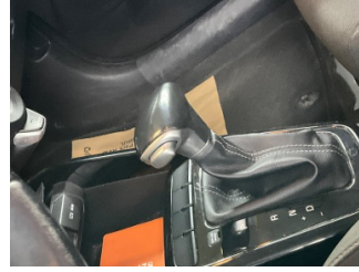
Şanzıman, Vites topuzu > Deforme Olmuş
