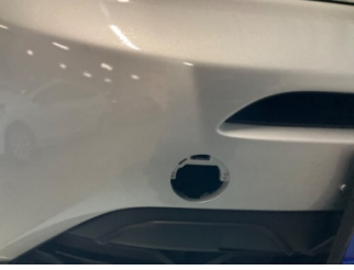
Tampon, ön, Çeki demir kapağı > Sökülmüş-Yok
