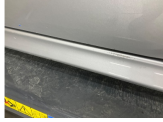
Marşbiyel, sol, Marşbiyel, sol > Boyası Atmış
