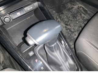
Şanzıman, Vites topuzu > Deforme Olmuş
