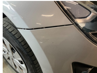
Tampon, ön, Ön tampon > Sabitlemesi Hatalı
