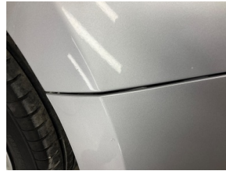
Tampon, arka, Arka tampon > Sabitlemesi Hatalı
