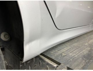
Marşbiyel, sağ, Marşbiyel, sağ > Hasarlı
