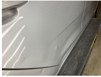
Kapı, sağ arka, Kapı, sağ arka > Hasarlı
