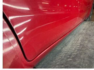
Kapı, sağ arka, Kapı, sağ arka > Ezik
