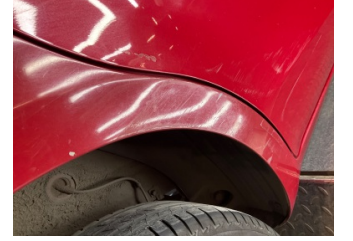
Çamurluk, sağ arka, Çamurluk, sağ arka > Ezik
