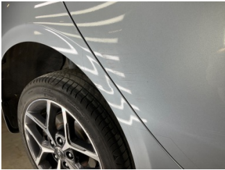
Çamurluk, sağ arka, Çamurluk, sağ arka > Ezik
