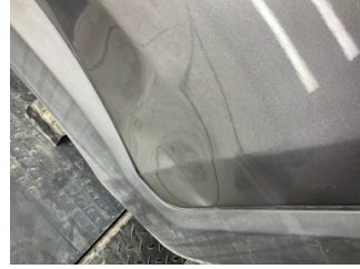
Kapı, sol arka, Kapı, sol arka > Hasarlı
