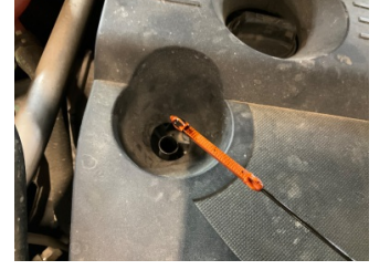
Motor, Yağ seviyesi > Eksik
