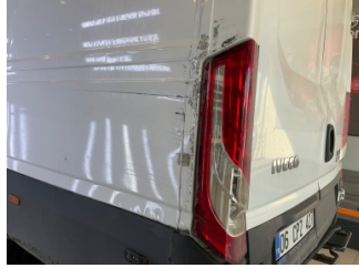
Çamurluk, sol arka, Çamurluk, sol arka > Hasarlı
