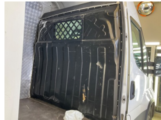
Döşemeler/Kapaklar, Bagaj bölümü döşemesi > Hasarlı
