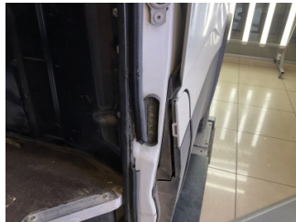
Kapı, sağ arka, Kapı fitili > Hasarlı
