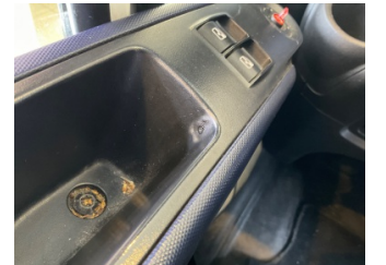
Döşemeler/Kapaklar, Döşemeler/Kapaklar > Yakıcı Madde ile Zarar Görmüş
