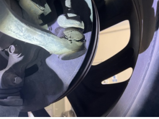
Direksiyon sistemi, Rot kolu/Rot başı, sağ > Hasarlı
