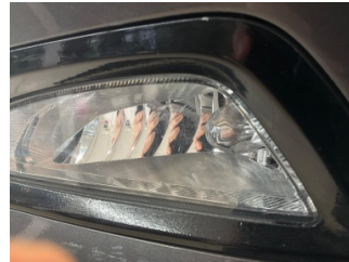
Sis lambaları, Sis farı camı, sol > Çatlak
