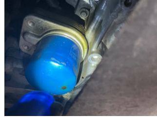
Motor, Yağ filtresi > Yağ Kaçağı
