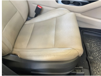
Döşemeler/Kapaklar, Döşemeler/Kapaklar > Deforme Olmuş
