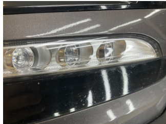
Sis lambaları, Sis farı camı, sağ > Hasarlı
