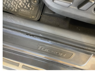
Kapı, sol ön, Kapı fitili > Hasarlı
