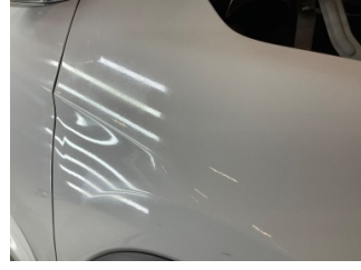
Çamurluk, sağ, Çamurluk, sağ > Deforme Olmuş
