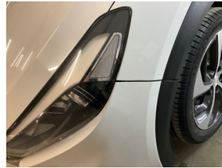
Tampon, ön, Ön tampon > Sabitlemesi Hatalı
