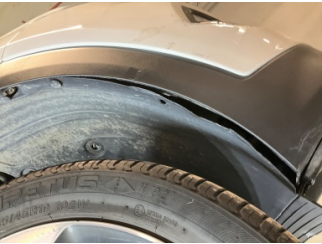
Çamurluk, sağ, Çamurluk, sağ > Sabitlemesi Hatalı
