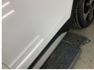
Kapı, sol arka, Kapı, sol arka > Çizik
