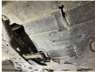
Motor, Alt muhafaza > Hasarlı
