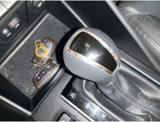
Şanzıman, Vites topuzu > Deforme Olmuş
