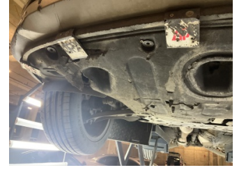
Motor, Alt muhafaza > Hasarlı
