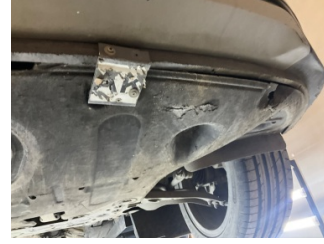
Motor, Alt muhafaza > Hasarlı
