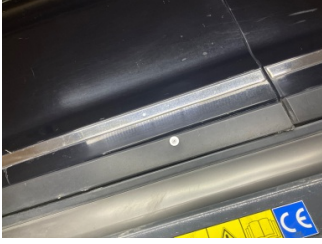
Kapı, sol ön, Kapı bandı > Standart Dışı Onarım
