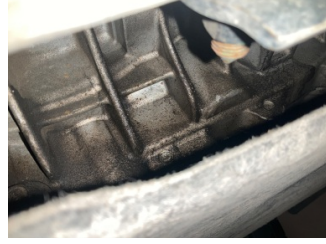
Şanzıman, Şanzıman > Yağ Kaçağı
