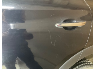
Kapı, sol arka, Kapı, sol arka > Çizik
