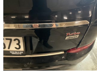
Bagaj kapağı/kapısı, Bagaj kapısı > Ezik
