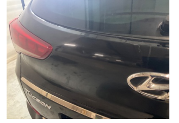
Bagaj kapağı/kapısı, Bagaj kapısı > Ezik
