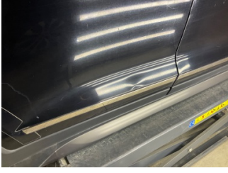
Kapı, sağ arka, Kapı, sağ arka > Ezik
