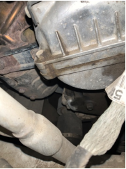
Motor, Motor > Yağ Kaçağı
