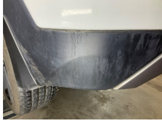
Tampon, arka, Spoiler > Deforme Olmuş
