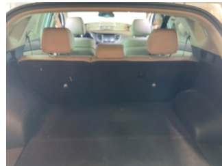
Döşemeler/Kapaklar, Pandizot > Sökülmüş-Yok
