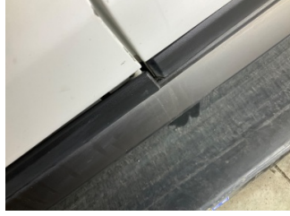
Kapı, sol ön, Kapı bandı > Sabitlemesi Hatalı
