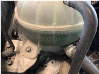
Motorsoğutması, Soğutma sıvısı > Eksik
