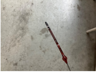
Motor, Yağ seviyesi > Eksik
