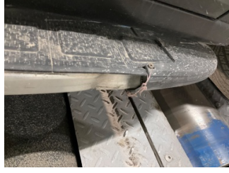
Marşbiyel, sağ, Marşbiyel plastiği, sağ > Hasarlı
