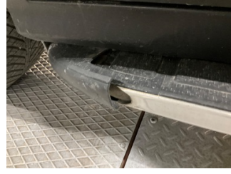
Marşbiyel, sağ, Marşbiyel plastiği, sağ > Hasarlı
