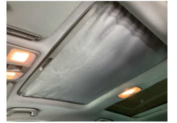
Döşemeler/Kapaklar, Tavan döşemesi > Deforme Olmuş
