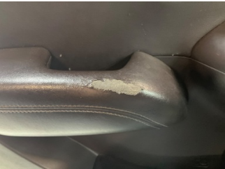
Döşemeler/Kapaklar, Kapı döşemesi, sol ön > Deforme Olmuş
