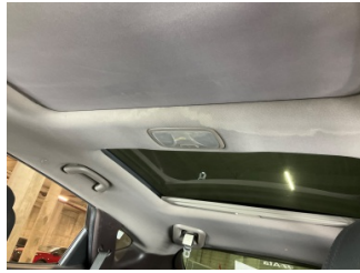
Döşemeler/Kapaklar, Tavan döşemesi > Kirlenmiş
