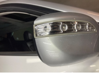
Dikiz aynası, sağı, Dış dikiz aynası kapağı > Çizik
