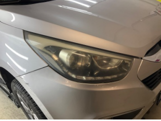
Farlar, Far camı, sağ > Deforme Olmuş
