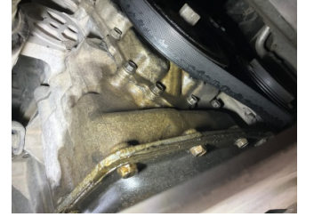
Motor, Motor > Yağ Kaçağı
