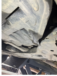
Motor, Alt muhafaza > Hasarlı
