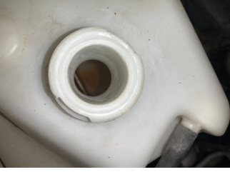
Motorsoğutması, Soğutma sıvısı > Eksik
