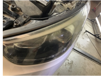
Farlar, Far camı, sol > Deforme Olmuş
