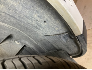
Çamurluk, sağ, Davlumbaz > Kırılmış
