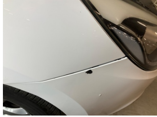
Tampon, ön, Ön tampon > Sabitlemesi Hatalı
