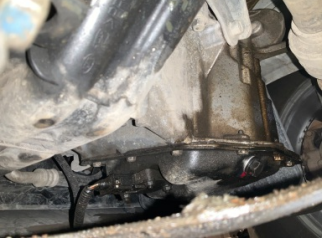
Motor, Motor > Yağ Kaçığı
