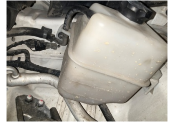
Motorsuğutması, Soğutma sıvısı > Eksik
