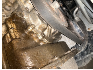
Motor, Motor > Yağ Kaçığı
