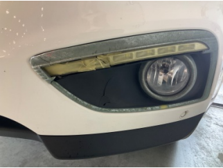
Sis lambaları, Sis farı camı, sol > Hasarlı
