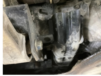
Motor, Motor > Yağ Kaçığı
