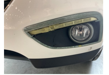
Sis lambaları, Sis Izgarası Sol > Hasarlı
