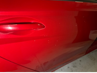
Kapı, sağ arka, Kapı, sağ arka > Çizik
