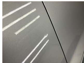
Kapı, sol ön, Kapı, sol ön > Ezik
