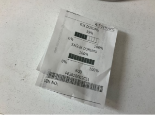
Elektrik donanımı/Pano, Akü > Test Sonucu
