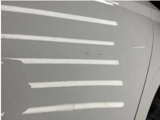
Kapı, sol arka, Kapı, sol arka > Çizik
