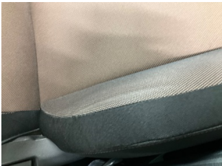
Döşemeler/Kapaklar, Döşemeler/Kapaklar > Deforme Olmuş
