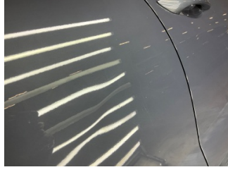
Kapı, sağ arka, Kapı, sağ arka > Ezik
