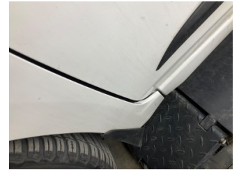
Çamurluk, sol, Çamurluk, sol > Sabitlenmesi Hatalı
