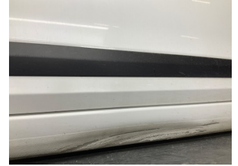
Marşbiyel, sağ, Marşbiyel, sağ > Hasarlı
