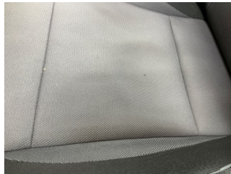
Döşemeler/Kapaklar, Döşemeler/Kapaklar > Yakıcı Madde ile Zarar Görmüş
