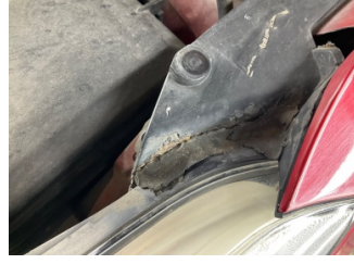
Farlar, Far camı, sol > Standart Dışı Onarım
