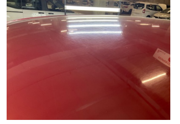
Tavan, Tavan > Dolu Hasarı
