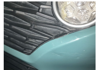
Tampon, ön, Ön tampon ızgarası > Standart Dışı Onarım
