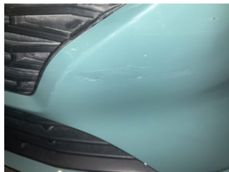
Tampon, ön, Ön tampon > Çatlak
